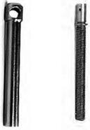
**HORIZONTAL STABILIZER ADJUSTING SCREW AND BARREL**
